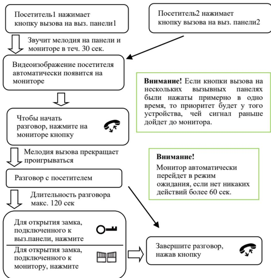
В режиме вызова абонент может использовать [функциональные кнопки](#) для управления вызовом, создания ручных снимков и видеофайлов, разблокировки подключенных замков. Для выбора определенной функции используйте кнопки навигации и на панели управления. Чтобы выбрать функцию нажмите кнопку настроек .
