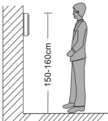
☞ Перед установкой монитора рекомендуем в стену вмонтировать монтажную коробку (не входит в комплект поставки) с расстоянием между отверстиями крепления не более 60 мм. В монтажной коробке удобно разместить всю коммутацию и при необходимости адаптер для сопряжения с подъездным многоквартирным домофоном.
