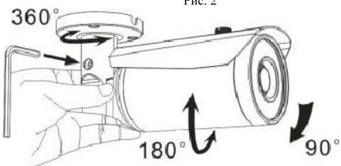
11. После настройки необходимой зоны наблюдения зафиксируйте камеру в выбранном положении, затянув при помощи шестигранника винт фиксации кронштейна (см. рис. 2).
